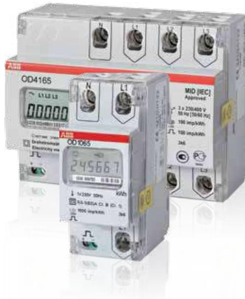
Счетчики серии ODIN являются основными счетчиками, устанавливаемыми в однофазных или трехфазных (4-х проводных) сетях. Счетчики монтируются на DIN-рейку и могут устанавливаться в распределительных щитах и небольших корпусах. Счетчики предназначены для измерения активной энергии. Прибор не требует программирования (за исключением случаев настройки коэффициента трансформации для модели OD 4110), что обеспечивает счетчику множество областей применения.
