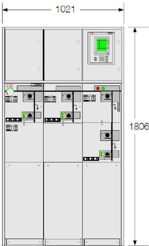
Низковольтный отсек с устройством REF541
