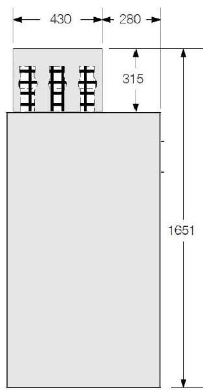
Крышка шинного отсека
