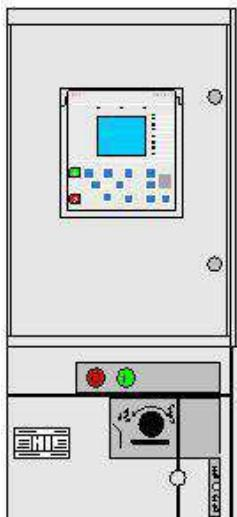
Низковольтный отсек с устройством REF615
