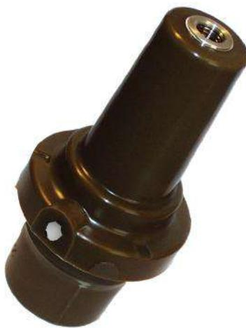
Присоединение высоковольтных кабелей производится при помощи кабельных вводов. Проводники залиты в изолирующий корпус ввода. Дополнительно, в корпусе ввода может находиться проводящий экран, выполняющий функцию ёмкостного делителя для индикации напряжения.
