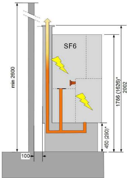
\* П отдельному заказу – каркас с основанием 290 мм.
