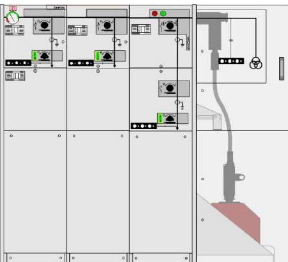
Измерительный модуль подключен сбоку
