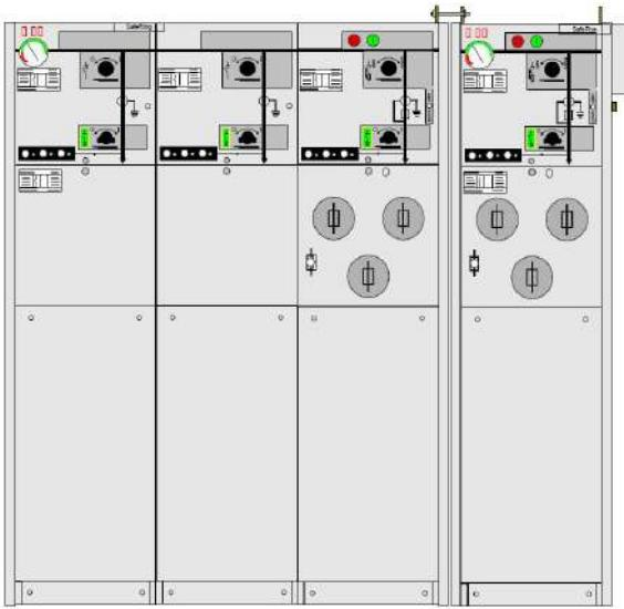
На модулях С и F SafeRing/SafePlus можно установить вводы для расширения сборными шинами слева или справа. Номинальный ток бокового расширения ограничен 400 А.
