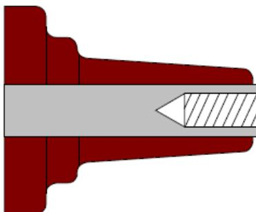
Интерфейс С с креплением двумя болтами M16 x 2 (метрическая резьба)
