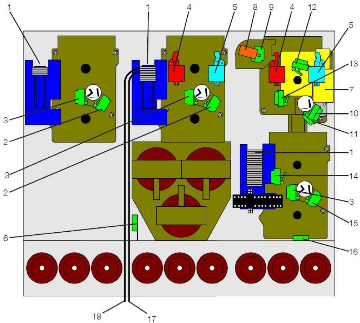
KRUЭ SafePlus состоящее из модулей CFV оснащённых различными вспомогательными контактами, катушками и двигателевым приводом
