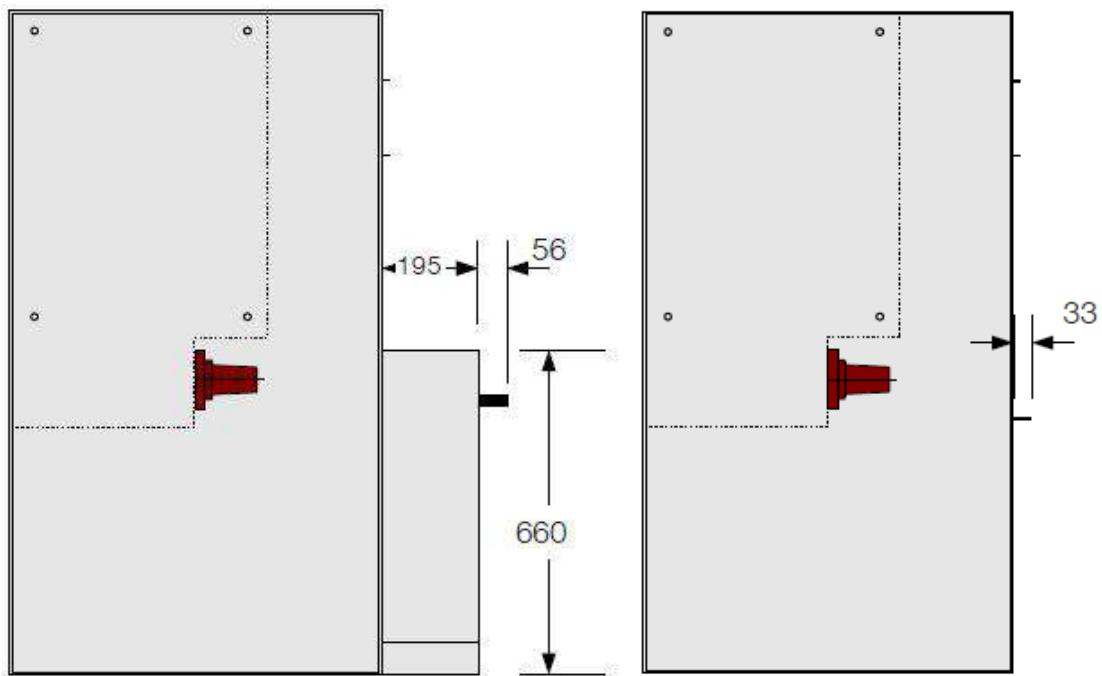
Крышка кабельного отсека для подключения сдвоенного кабеля
