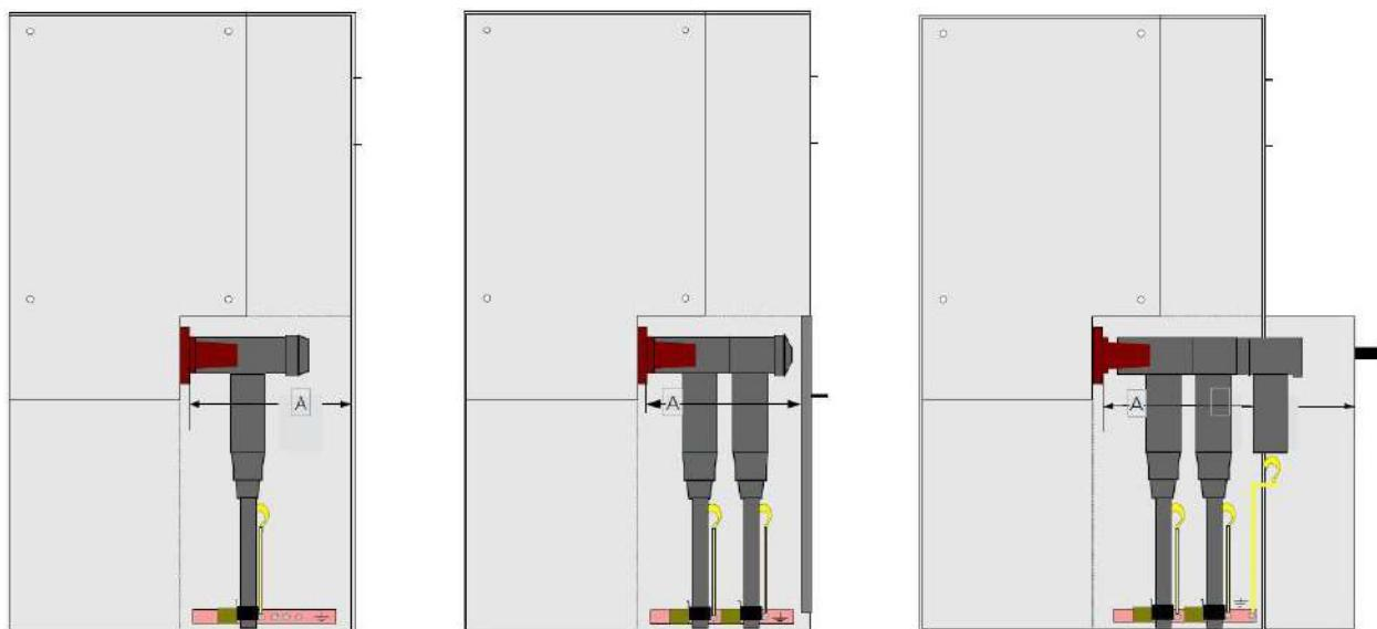
В приведенной ниже таблице указано расстояние «A» в миллиметрах от крайней точки кабельного ввода до ближайшей точки крышки кабельного отсека.
