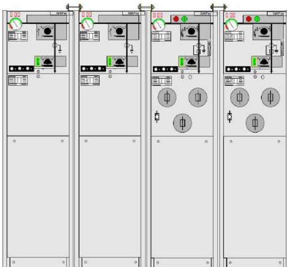
Конструкция SafePlus может быть полностью модульной. Шины соединения модулей и концевые адаптеры, используемые на крайних модулях, идентичны шинам, используемым в предыдущем примере.
