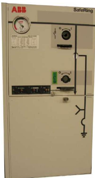
В качестве дополнительного оборудования, модули С и De могут оборудоваться втулками для испытания кабелей, которые расположены за нижней передней крышкой. Эта крышка может иметь блокировку в зависимости от положения заземлителя, что позволит исключить доступ к втулкам до того как заземлитель будет замкнут.
