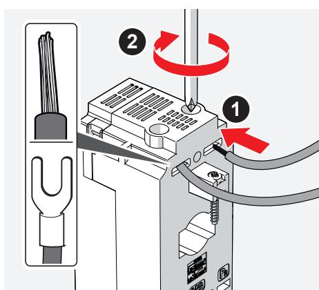
В случае использования винтовых клемм на вторичной обмотке трансформатора тока, подключение должно выполняться кабелями с вилочными наконечниками или же с защищенной изоляцией, соблюдая указания, приводимые непосредственно на изделии.
