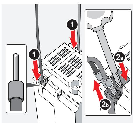
Электропроводка с безвинтовыми клеммами выполняется кабелями с штыревыми наконечниками, без использования инструмента для крепления. После установки трансформатора можно закрепить закрывающуюся на замок крышку с проволокой для пломбы.
