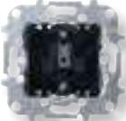
Розетка с заземлением SCHUKO (без лапок)              | 8188    | 16 А; 250 В~<br>С винтовыми клеммами.<br>С защитными шторками.<br>Накладка: арт. 8588 хх                                                                                                                                        |
