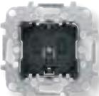
Розетка с заземлением SCHUKO, с контрольной подсветкой, без лапок | 8188.8  | 16 А; 250 В~<br>Со встроенной лампой визуального контроля наличия напряжения.<br>С защитными шторками.<br>Накладка: арт. 8588.8 хх |
