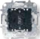
Розетка с заземлением SCHUKO с безвинтовыми клеммами | 8188.6  | 16 А; 250 В~<br>Автоматические безвинтовые/втычные клеммы.<br>Высокий уровень электро-пожаробезопасности за счёт эффекта "самоподжима".<br>Сокращает время установки на 40%.<br>С защитными шторками.<br>Накладка: арт. 8588 хх |
