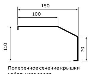
Поперечное сечение крышки кабельного ввода
